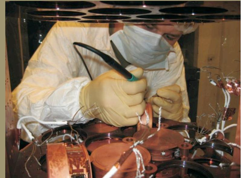
Armado del detector de materia oscura Edelweiss (© LSM)
