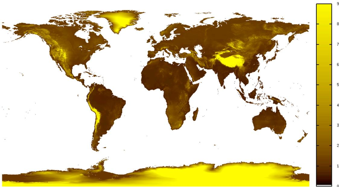
Figura 3: flujo de neutrones relativo al flujo a nivel del mar promediado al ecuador. El flujo esta directamente relacionado a la altitud en el lugar con un efecto secundario relacionado a la latitud geomagnética.
