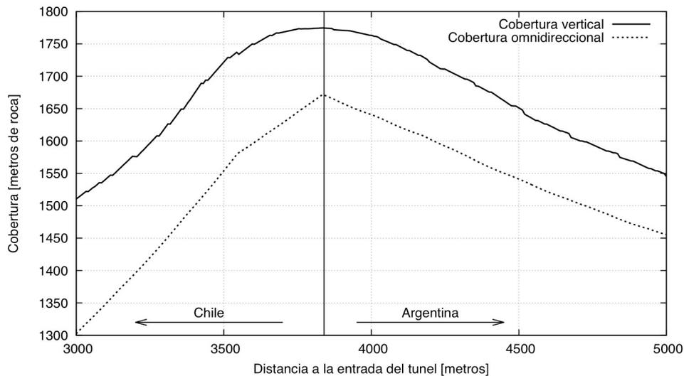
Figura 2: profundidad vertical y omnidireccional como función de la posición del laboratorio respecto a la entrada del túnel del lado chileno.
